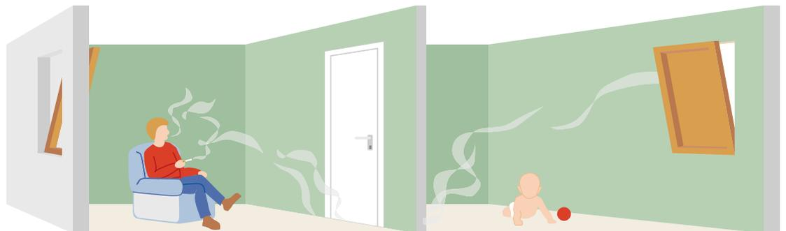
Fensterlüftung ist Zufallslüftung
