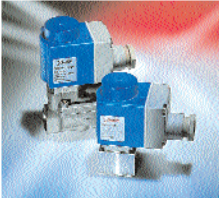
Abb. 4: Die beiden Edelstahlventile EV 212 B und EV 222 B verfügen über eine integrierte Trennmembran. Sie eignen sich vor allem für den Einsatz in aggressiven Medien und schmutzanfälligen Bereichen.
